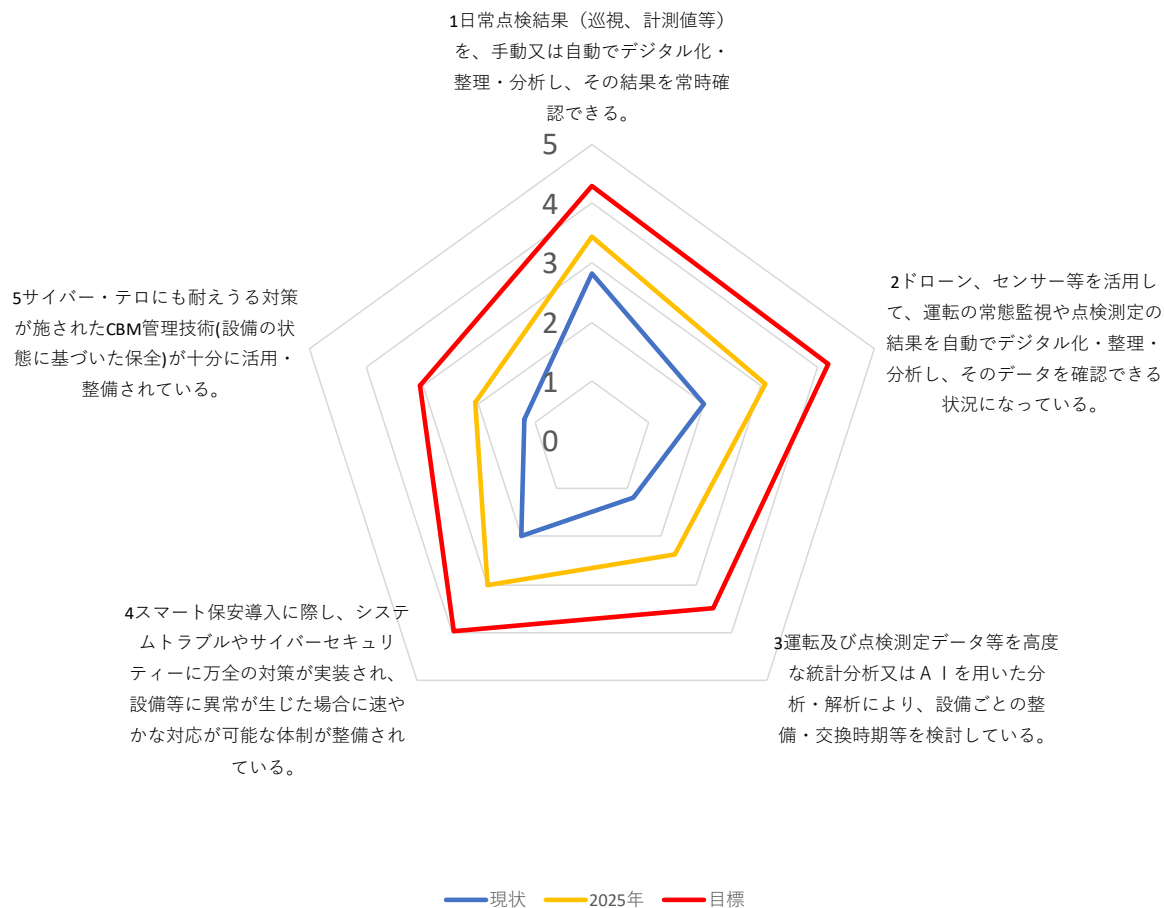
Figure 2-72 風力発電における CBM 管理の目標と現状および 2025 年の取組状況
