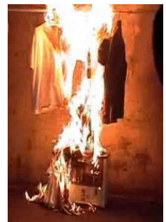
衣類がストーブの火に接触して発火する様子
