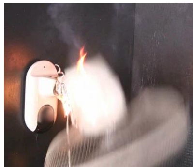
写真2. 内部配線の劣化により発火
