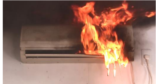
写真1. 内部に洗浄液がかかりトラッキング現象で発火
