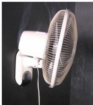
写真2. 内部配線の劣化により発火
