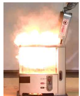
(写真)カートリッジタンクのふたが外れて灯油が高温部にかかり発火
