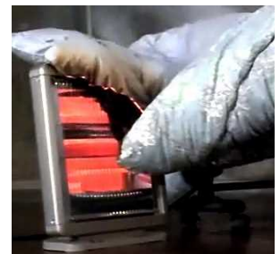
(写真) 電気ストーブに布団が接触して過熱される様子
