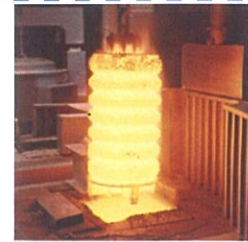
鉄（てつ）の板（いた）をおしつぶして薄（うす）くするときにつかわれるロールという部品（ぶひん）。重さが400キログラムくらいあります
