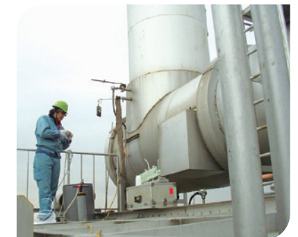
排出口付近でのVOC濃度測定
