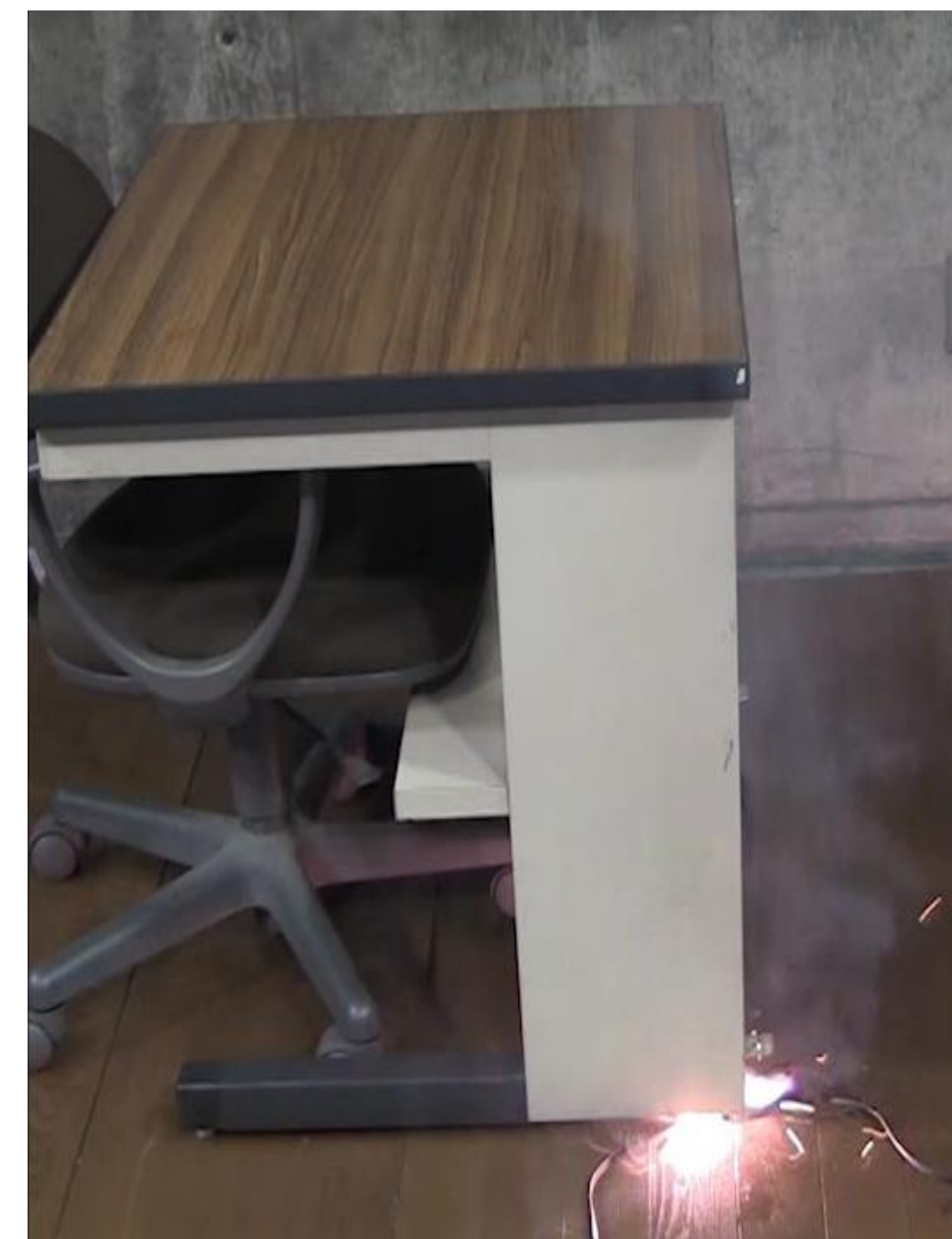
【NITEの再現実験】机の脚に踏み付けられていたコードから発火
