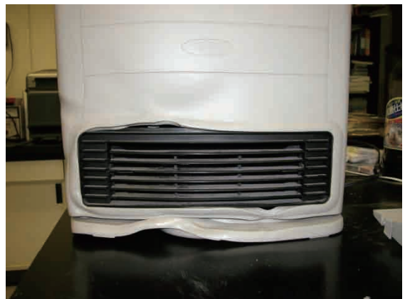
購入後一度もフィルター掃除をせず、2シーズン使用した電気ファンヒーター。吹き出し口の温度が通常より高くなり、外郭が熱変形した
