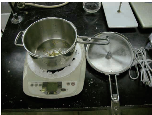
取扱説明書を読まず、量を大幅にオーバーして大豆を入れたため、内圧が異常に上昇し、破裂してしまった圧力鍋。熱源のIH調理器のトッププレートも粉々に割れてしまった
